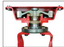
Rotores con engranajes montados sobre cojinetes cónicos a sellado especial tipo Combi sobre contenedor de 8+8 mm. Dientes a hojas de longitud 33 cm con espesores de 1,6 cm.
