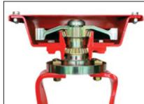
Rotor con engranajes montados sobre cojinetes cónicos a sellado especial Combi en el contenedor de 6+6 mm. Dientes con hojas de 30cm con espesor de 1,5 cm.
