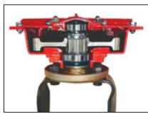
5 rotores por metro (Paso 20 cm), rotores con engranajes montados sobre cojinetes a esferas sobre recipiente 4 mm con refuerzos internos. Dientes a hojas de 26 cm de longitud con espesor de 0,8 cm.
