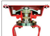
Rotores con engranajes montados sobre cojinetes
