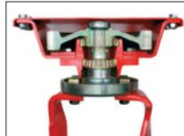
Rotores con engranajes cementados. Cojinetes a sellado especial Cassetta sobre un recipiente de 8+8 mm. Dientes a hoja de 33 cm de longitud con espesor de 1,6 cm.
