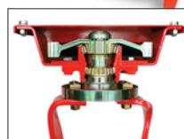
Rotores con engranajes montados sobre cojinetes cónicos a
