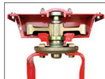
Rotores montantes sobre cojinetes a esferas en recipientes de 4 mm. Engranajes con masa mayorada, entre ejes de 25 cm. Dientes a hojas de 28 cm con espesor de 1,2 cm.
