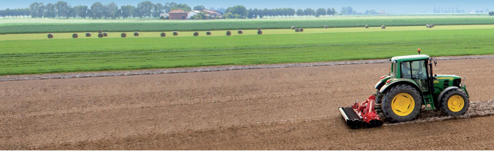
Las Gradas Eternum poseen robustez y confiabilidad excepcionales ideales para trabajos duros en extremas condiciones. La durabilidad es tan elevada que se olvidará el año en que el equipo fue comprado. Bastidor excepcionalmente robusto, engranajes montados sobre cojinetes cónicos, disponibles con sistema patentado Rapident para rápida sustitución de los dientes del centro del rotor. **Los modelos S y R son ideales para grandes empresas o contratistas.**
